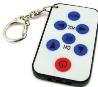
Rysunek 1. A – pilot w pełni zgodny ze standardem RC5 (możliwość zmiany opisów klawiszy). B – pilot uniwersalny, nadający w wielu różnych standardach do wyboru za pomocą konfiguracji (RC5, Sony, Daewoo itp.). Piloty dostępne na: www.sklep.atnel.pl
