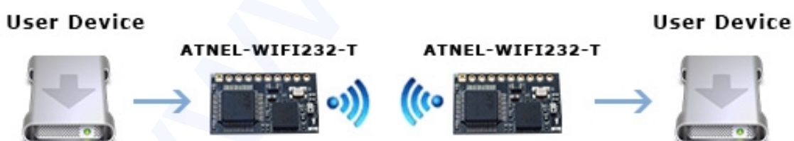
Rysunek 26. Zastosowanie transparentnego portu szeregowego
